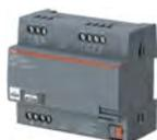
Soporta 2/4 tubos para la calefacción y la refrigeración. Tres contactos para conectar 3 velocidades. Dos contactos para activar las válvulas de calefacción y refrigeración. Dos entradas binarias para conectar el punto de rocío y contactos de condensación. Soporta válvulas de 24 V y 230 V. Salidas: 3x Contacto normalmente abierto, libre de potencial. Tipo de carga: AC3. Corriente nominal: 6 A. Tensión de salida: 230 V. Clase de protección del dispositivo: IP 20
