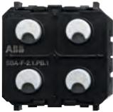
Actuador de persianas integrado para controlar persianas o toldos. Función persiana pre-configurada. La función del sensor puede modificarse. Pilotos: LED a modo de luz de orientación o como indicación del estado de conmutación. Salidas: 1x contacto de conmutación normalmente abierto, potencial limitado. Tipo de carga: control de persianas. Corriente nominal: 4 A. Tensión de salida: 230 V~. Potencia nominal: 920 VA. Tapa ref. SR-4-N2.
