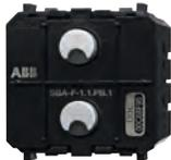
Actuador de persianas integrado para controlar persianas o toldos. Función persiana pre-configurada. La función del sensor puede modificarse. Elementos de control: contactos táctiles arriba / abajo. Pilotos: LED a modo de luz de orientación o como indicación del estado de conmutación. Salidas: 1x contacto de conmutación normalmente abierto, potencial limitado. Tipo de carga: control de persianas. Corriente nominal: 4 A. Tensión de salida: 230 V~. Potencia nominal: 920 VA. Tapa ref. SR-2-N2.
