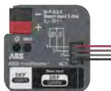
En la entrada binaria 2/4 los pulsadores convencionales o los contactos auxiliares se pueden utilizar para activar actuadores ABB-free@home® o para registrar información de estado. Posibilidad de alargar los cables de conexión máximo de 10 m.
