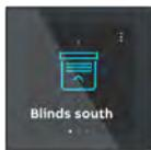
Panel táctil 4" - hasta 16 funciones con una pantalla IPS de 4" con resolución 480\*480 que ofrece control de la vivienda y monitorización del sistema ABB-free@home®, o ABB i-bus® KNX. Controle, observe y gestione toda su instalación en un solo dispositivo.
