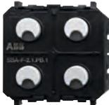
Actuador de persianas integrado para controlar persianas o toldos. Función persiana pre-configurada. La función del sensor puede modificarse. Pilotos: LED a modo de luz de orientación o como indicación del estado de conmutación. Salidas: 1x contacto de conmutación normalmente abierto, potencial limitado. Tipo de carga: control de persianas. Corriente nominal: 4 A. Tensión de salida: 230 V~. Potencia nominal: 920 VA. Tapa ref. SR-4-N2.
