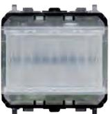
Para la conmutación automática de actuadores ABB-free@home® por movimiento y luminosidad. Con lente selectiva para la detección de acceso de animales. Tiempo de apagado configurable. Rango de detección: frontal: 6 m, lateral: 3 m. Angulo de detección: 180 ° Valor límite de luminosidad: 1 Lux - 500 Lux. Altura de montaje: 1.1 m - 1.3 m. Grado de protección: IP 20. Tapa ref. CP-MD-N2
