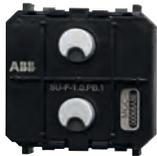
Para transmitir comandos de encendido y apagado, regulación y persianas a un actuador ABB-free@home®. Pilotos: LED a modo de luz de orientación o como indicación del estado de conmutación. Grado de protección: IP 20. Temperatura de funcionamiento: -5 ° C a 45 ° C. Profundidad de montaje: 9 mm. Tapa ref. SR-2-N2
