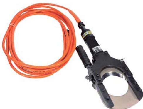
El cabezal CT-120M es adecuado para cortar cables en tensión que puedan estar accidentalmente energizados (hasta 220 kV), con el fin de prevenir accidentes durante los trabajos de reparación y mantenimiento. Está equipado con una manguera flexible de alta capacidad dieléctrica de 10 metros de longitud.
