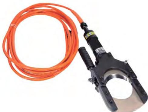
El cabezal CT-120M es adecuado para cortar cables en tensión que puedan estar accidentalmente energizados (hasta 220 kV), con el fin de prevenir accidentes durante los trabajos de reparación y mantenimiento. Está equipado con una manguera flexible de alta capacidad dieléctrica de 10 metros de longitud.
