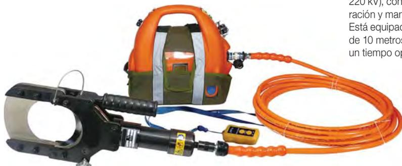
El kit aislado KH-120LV es adecuado para cortar cables de baja, media y alta tensión que puedan estar accidentalmente energizados (hasta 220 kV), con el fin de prevenir accidentes durante los trabajos de reparación y mantenimiento.
