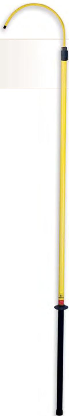
Pértigas de un solo tramo realizadas con tubo de poliéster y fibra de vidrio de  $\varnothing$  32 mm. Con obturaciones antihumedad en ambos extremos, guardamanos, empuñadura, contera, cabezal métrico M-10 y gancho de salvamento.
